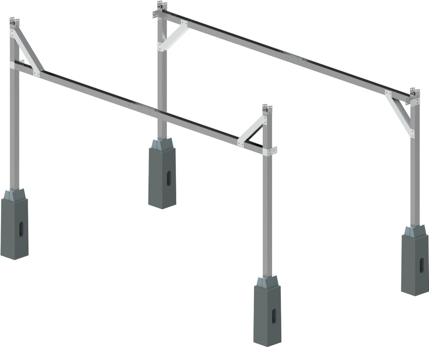
F. Verschrauben Sie die beide Querprofile (5) an der Stützpfeiler. Verwenden Sie hierzu untere Seitenverbinder (L3).
